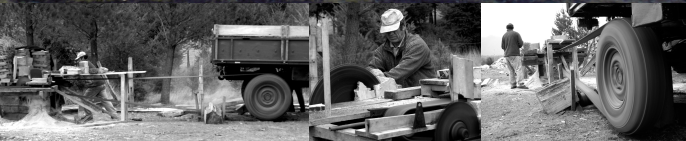
30.000 Tejuelas de madera construidas con un camión UNIMOG, en tercera marcha
